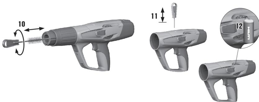
1. Vaporiser légèrement les segments de piston à l'aide d'huile lubrifiante et les nettoyer avec la brosse plate jusqu'à ce qu'ils puissent bouger sans entrave.
