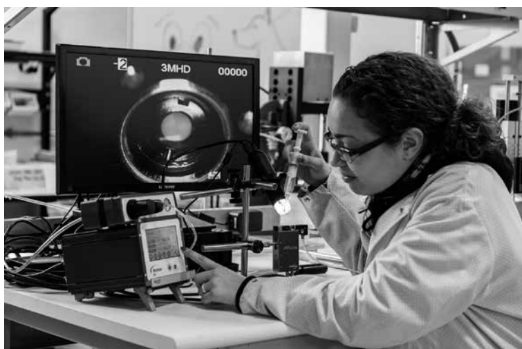
Рис. 2. Исходящий контроль — тестирование клапана PICO Pulse с контроллером PICO Touch перед отправкой заказчику
