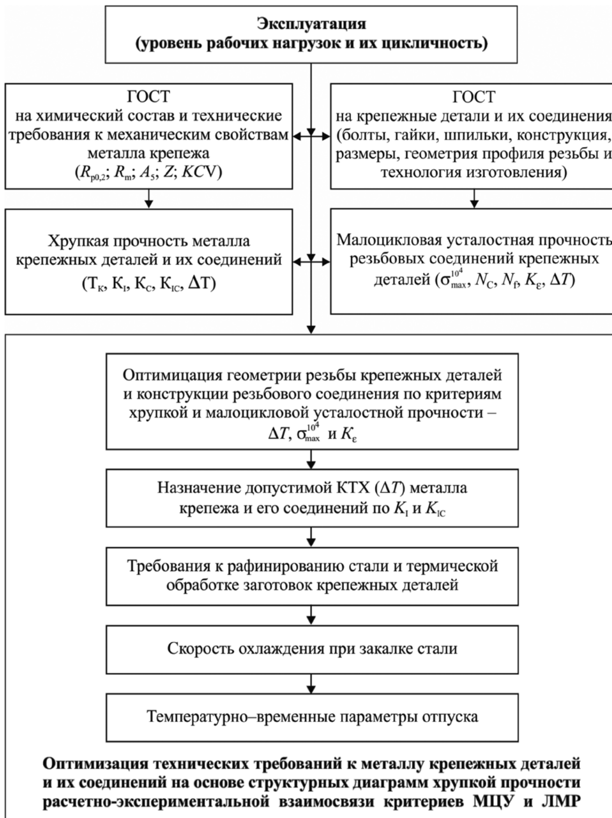
Рис. 4. Схема обоснования и оптимизации технических требований конструкторской документации и норм расчёта на прочность. Сокращения на схеме: МЦУ — малоцикловая усталость; ЛМР — линейная механика разрушения
