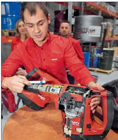
Устройство нового сетевого перфоратора серии TE 60
