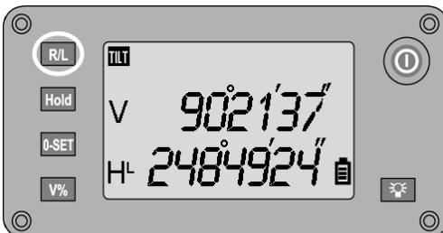
Smer merjenja za horizontalno merjenje kotov lahko s pritiskom na tipko **R/L** spreminjate med desno – v smeri urnega kazalca in levo – v nasprotni smeri urnega kazalca.
