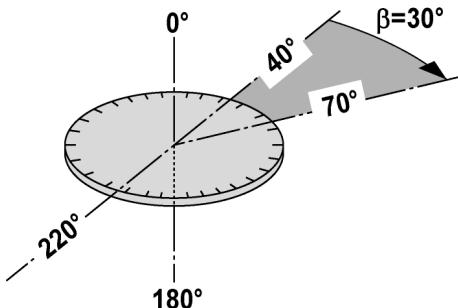
От снетите хоризонтални измервания на кръгове от  $70^\circ$  до едната цел и  $40^\circ$  до другата цел, включението ѝ може да бъде измерен  $70^\circ - 40^\circ = 30^\circ$ .
