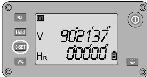
Отчитането на хоризонталния кръг по всяко време може да бъде извършено чрез натискане на бутона **0-SET** на нула и така да бъде поставена опорната или нулевата точка за хоризонталния кръг.
