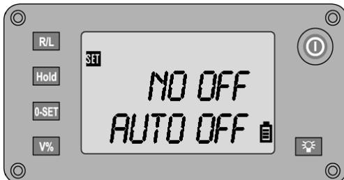
Включване, респ. изключване на автоматичното прекъсване на уреда
