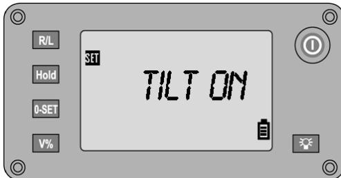
Включване,resp. изключване на компенсатора
