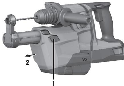
1. Schalten Sie den Rechts- / Linkslauf des Bohrhammers in Mittelstellung.
