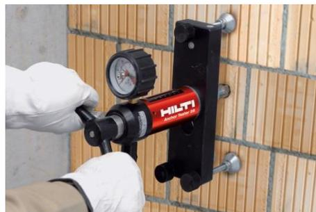
Для других типов пустотелого и полнотелого кирпича в кирпичной кладке, не описанных в данных ЕТА для химического анкера Hilti HIT-HY 270 или данном руководстве по техническим данным, нормативное сопротивление может определяться по результатам испытаний на растяжение, проводимых на площадке в соответствии с СТО 44416204-010-2010 “Крепления анкерные. Метод определения несущей способности по результатам натуральных испытаний”, или испытаний на приложение рабочей нагрузки по методике Hilti.
