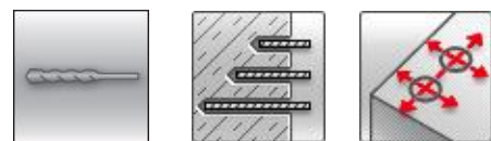
Ударное сверление Изменяемая глубина установки Небольшие краевые и межосевые расстояния
